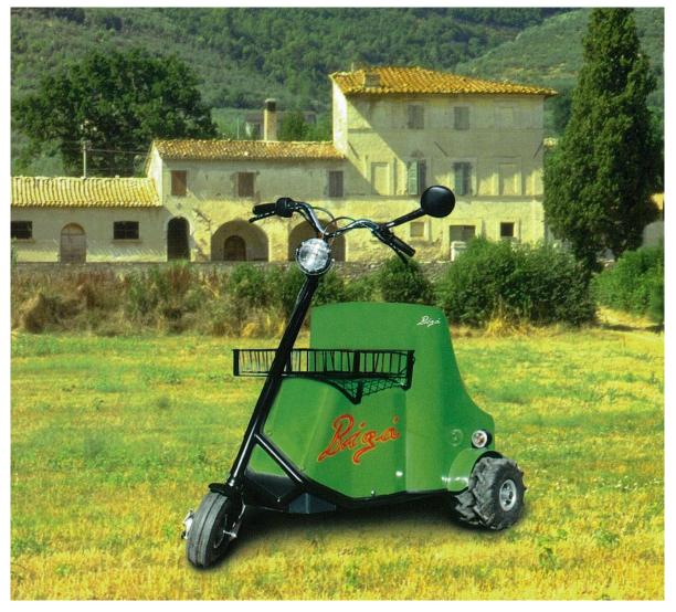
Lung. 120 cm / Largh. 85 cm / Altezza 120 cm — Velocità 6 km/h — Tipo C pendenza 45% solo operatore. Ruote gemellate 2+2 ruote posteriori tipo trattore. Ruota anteriore direzionale. Scocca in vetroresina riciclabile. Colori di serie: verde - arancio. Altri colori a richiesta.
