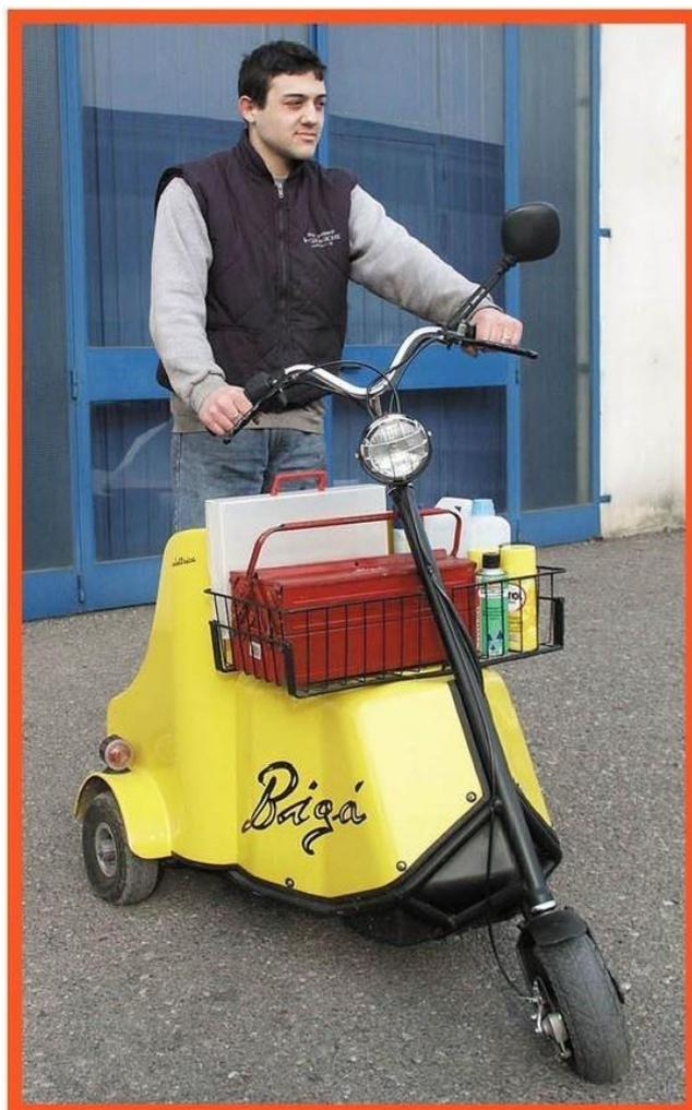
**Velocità 16 km/h - pendenza superabile 16% - carico 50 kg oltre il conducente**
